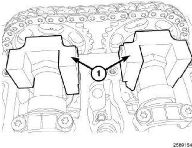
**Fig. 144: Camshaft Lock Tools**
