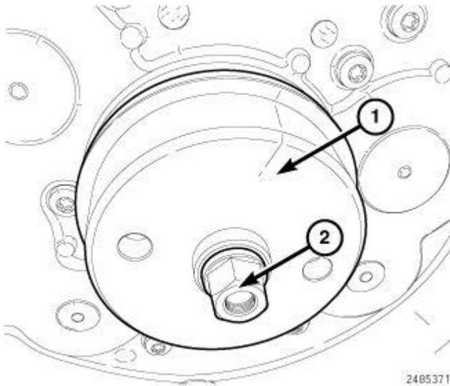
**Fig. 268: Seal Installer & Nut**
