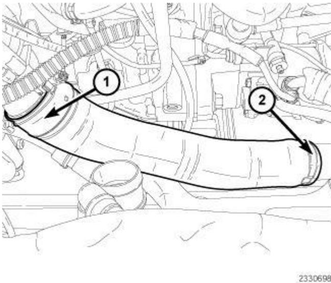
**Fig. 384: EGR Air Flow Control Valve & Clamp**
