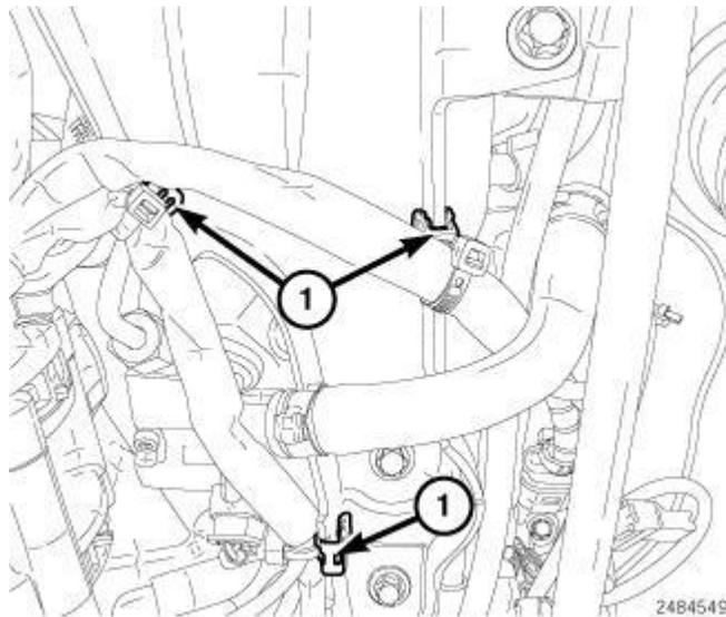
**Fig. 370: Wire Harness Retainers**
