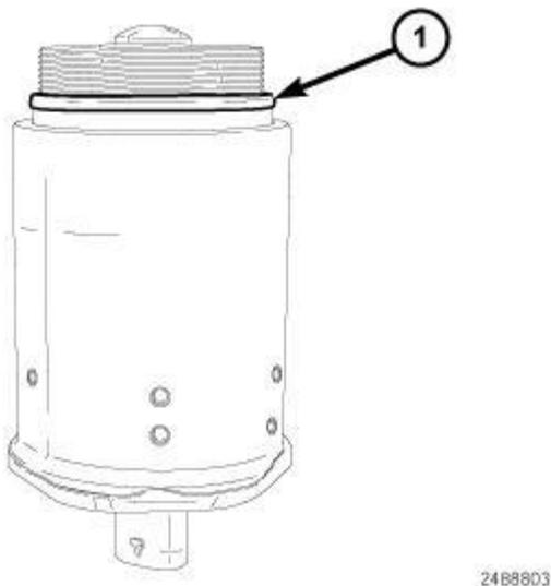
**Fig. 305: O-Ring Seal**
