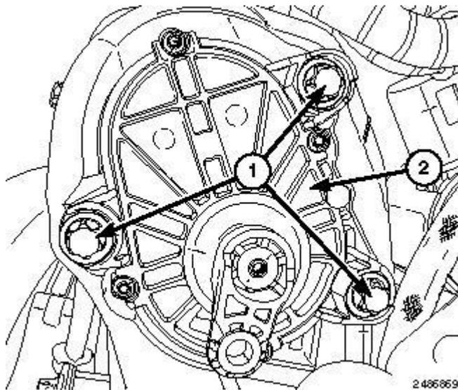
**Fig. 415: Swirl Valve Actuator & Bolts**
