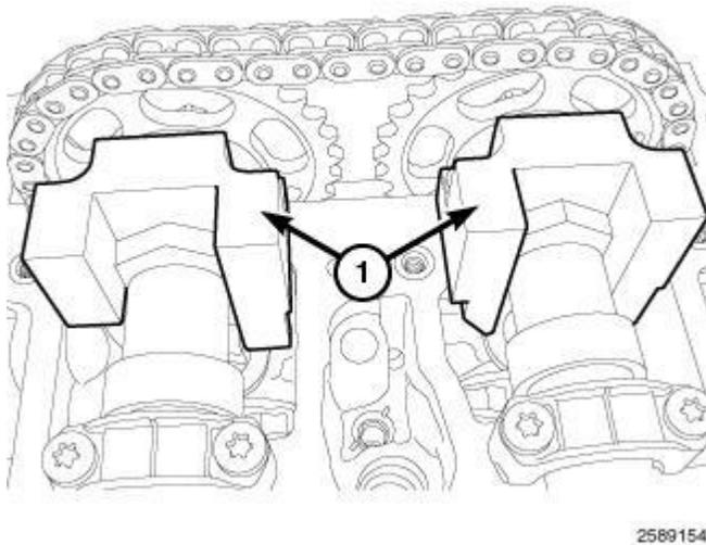
**Fig. 697: Camshaft Lock Tools**
