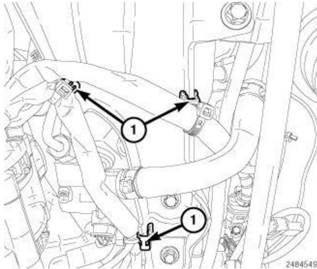
**Fig. 379: Wire Harness Retainers**
