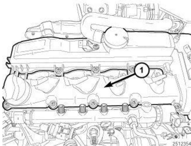
**Fig. 174: Cylinder Head Cover**
