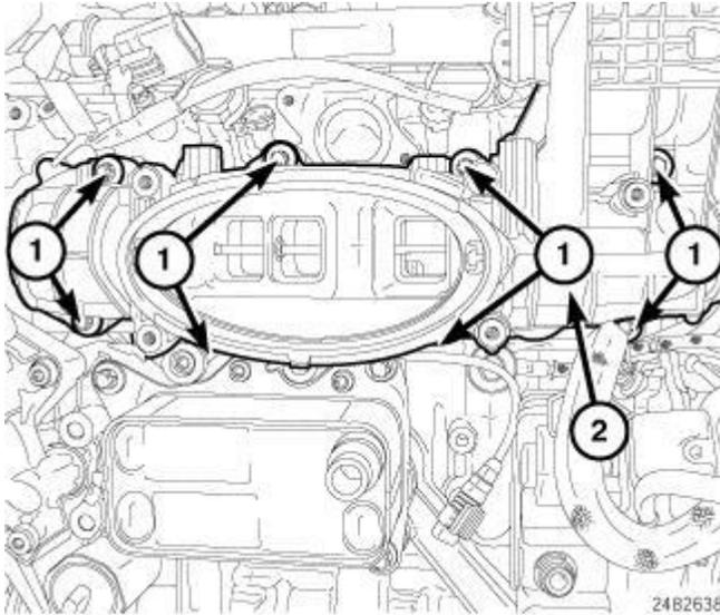
**Fig. 506: Intake Manifold & Bolts**
