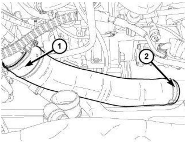
**Fig. 451: EGR Air Flow Control Valve & Clamp**
