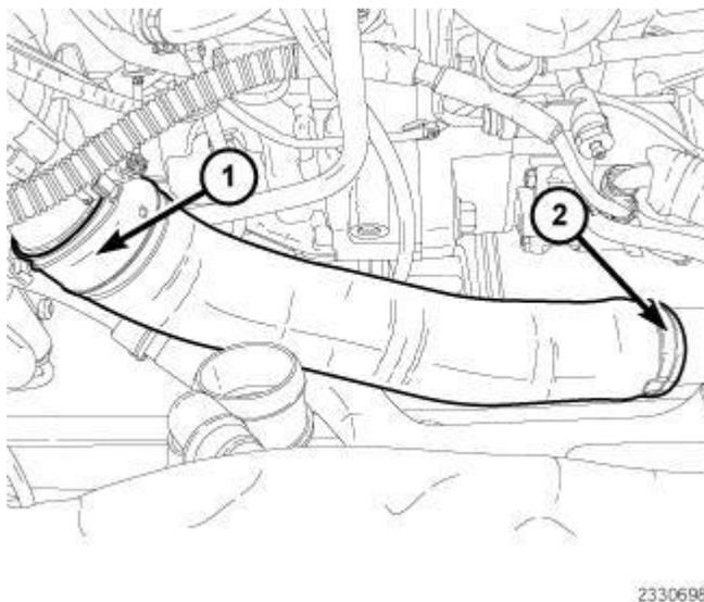
**Fig. 79: EGR Air Flow Control Valve & Clamp**
