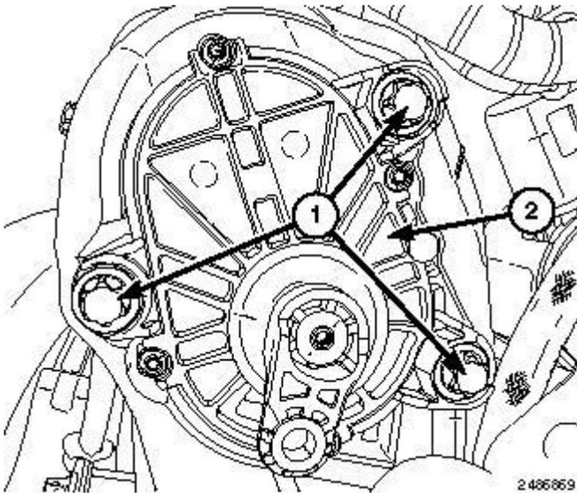
**Fig. 416: Swirl Valve Actuator & Bolts**
