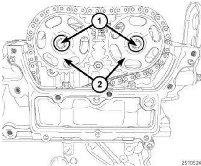
**Fig. 683: Camshaft Sprockets & Bolts**
