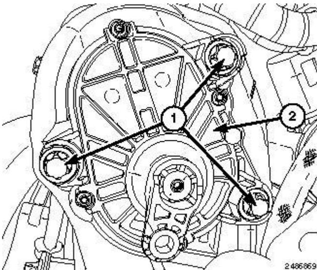
**Fig. 393: Swirl Valve Actuator & Bolts**
