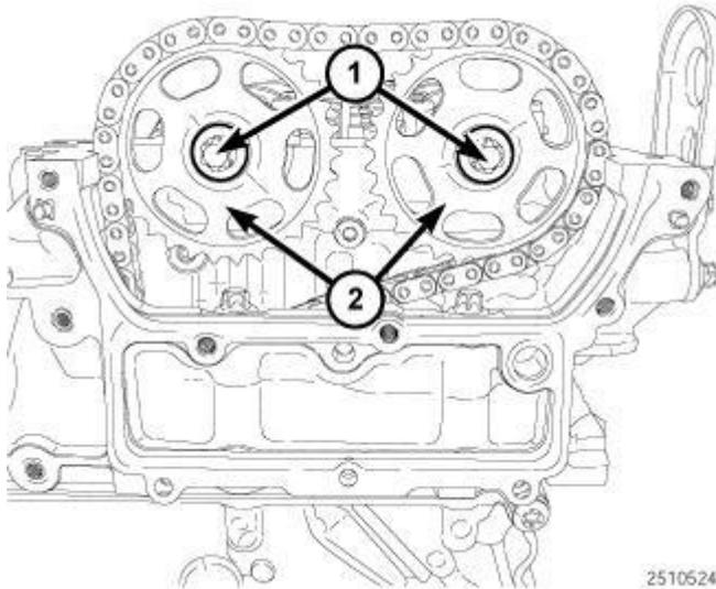
**Fig. 679: Camshaft Sprockets & Bolts**
