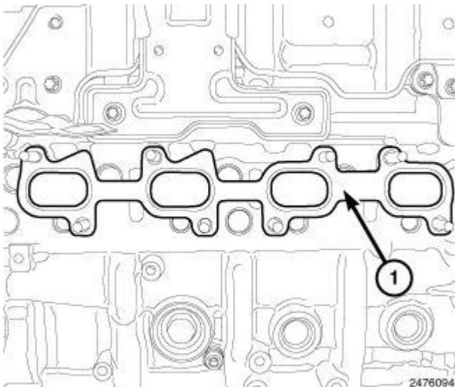
**Fig. 443: Exhaust Manifold Gasket**
