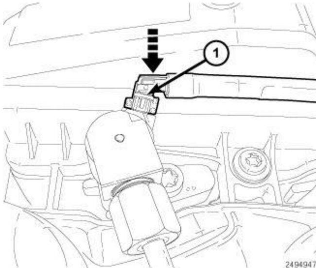
**Fig. 181: Installing Lock Tab**
