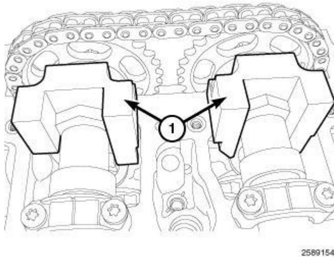
**Fig. 703: Camshaft Lock Tools**
