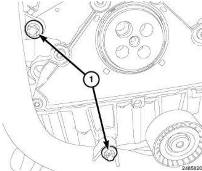
**Fig. 256: Coolant Tube Bolts**
