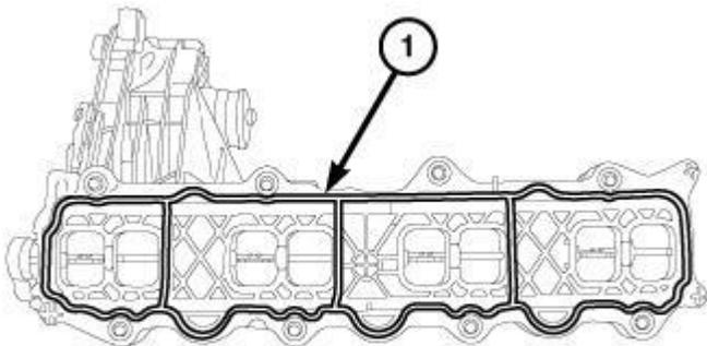
**Fig. 525: Intake Manifold Gasket**
