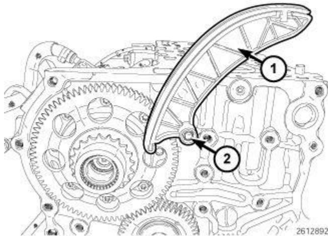
**Fig. 681: Tensioning Rail & Pin**
