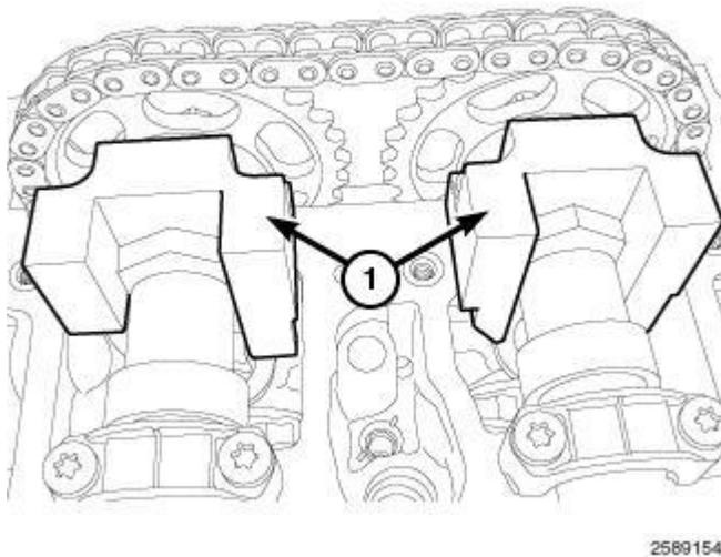
**Fig. 686: Camshaft Lock Tools**
