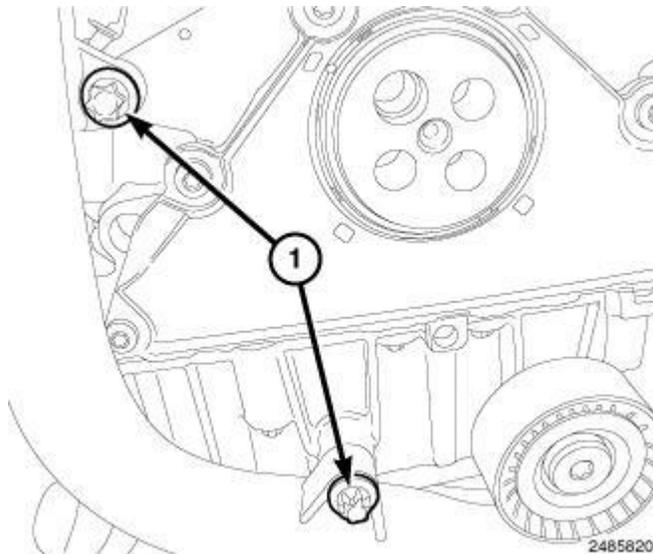
**Fig. 250: Coolant Tube Bolts**
