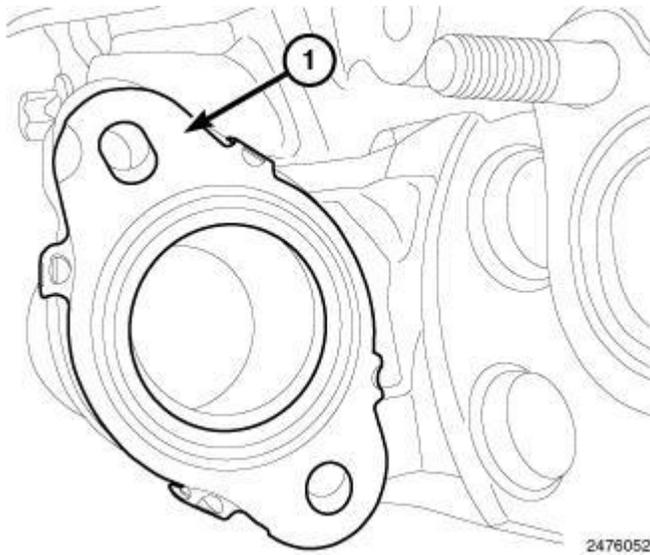
**Fig. 444: EGR Pipe Gasket**
