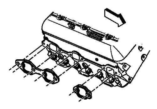
Fig. 334: Exhaust Manifold Gaskets
