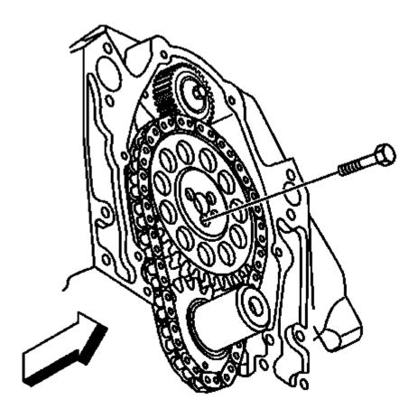
Fig. 203: Camshaft Sprocket Bolts
