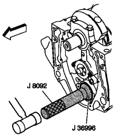
Fig. 608: Installing Balance Shaft
