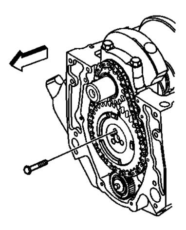
Fig. 620: Camshaft Sprocket & Bolts
