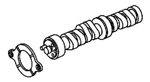
Fig. 485: Camshaft & Retainer Plate
