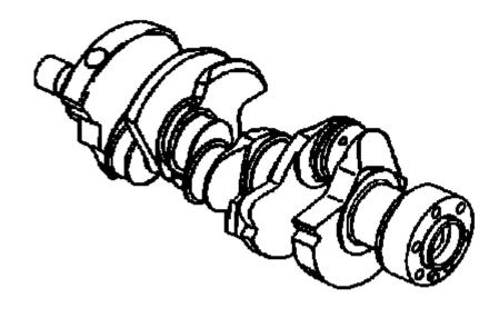
Fig. 442: Crankshaft
